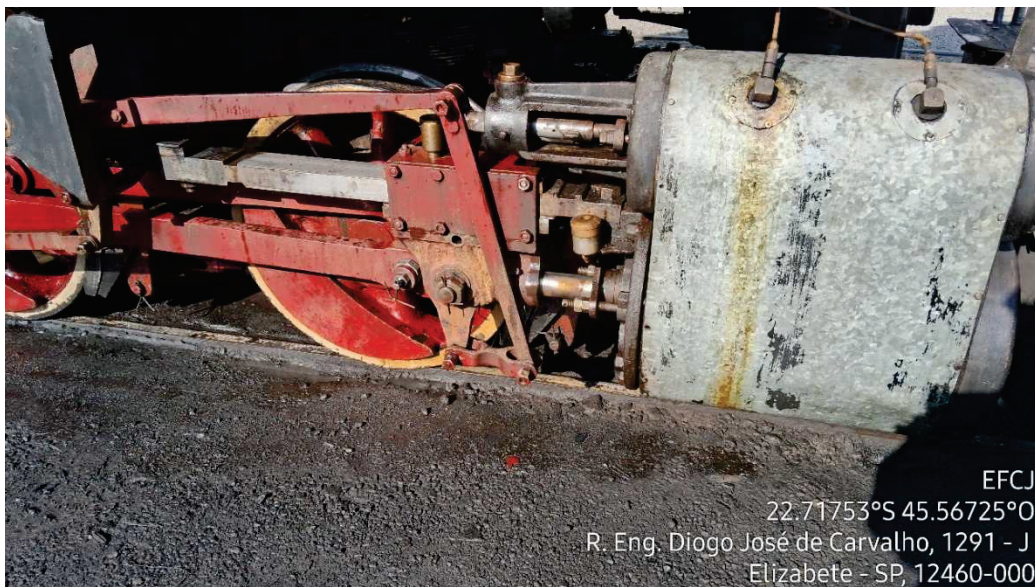
Figura 20 - Detalhe da locomotiva com vazamentos - Pátio de Manutenção Capivari
