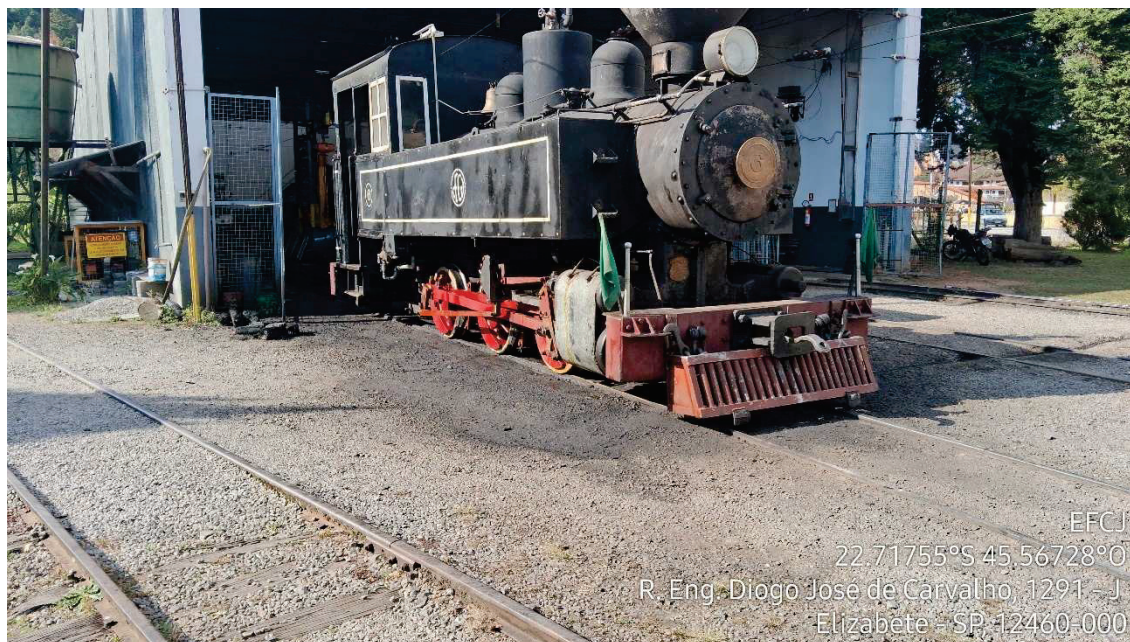
Figura 19 - Locomotiva com vazamentos de óleo - Pátio de Manutenção Capivari
