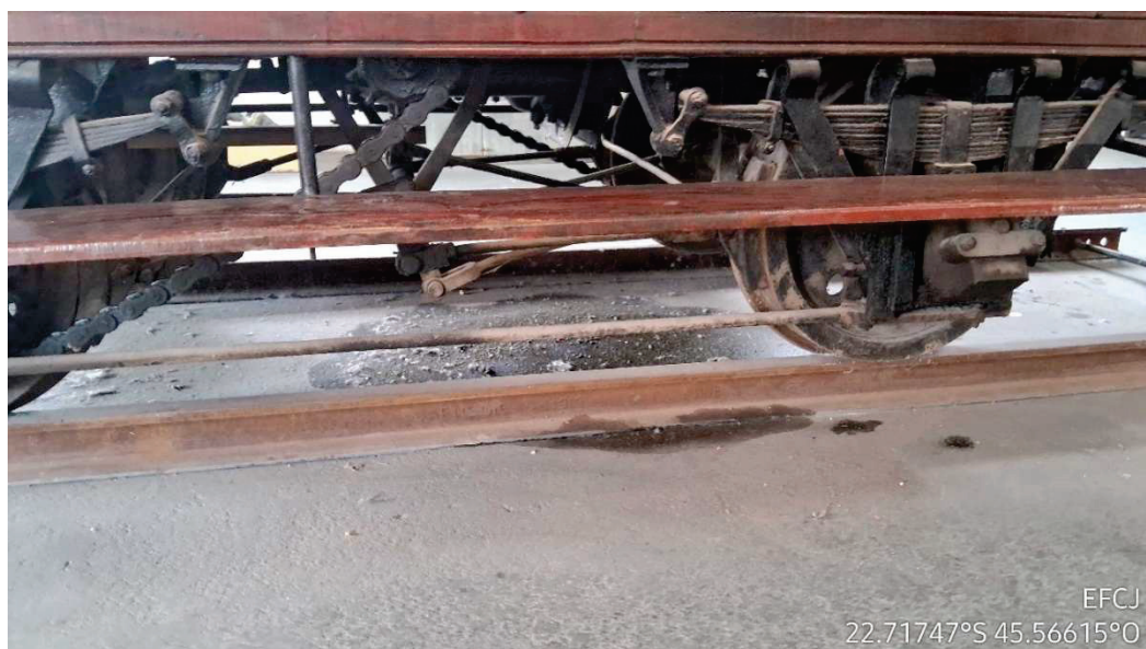
Figura 15 - Locomotiva de acervo histórico com vazamento de óleo - Centro de Memória Ferroviária de Campos do Jordão
