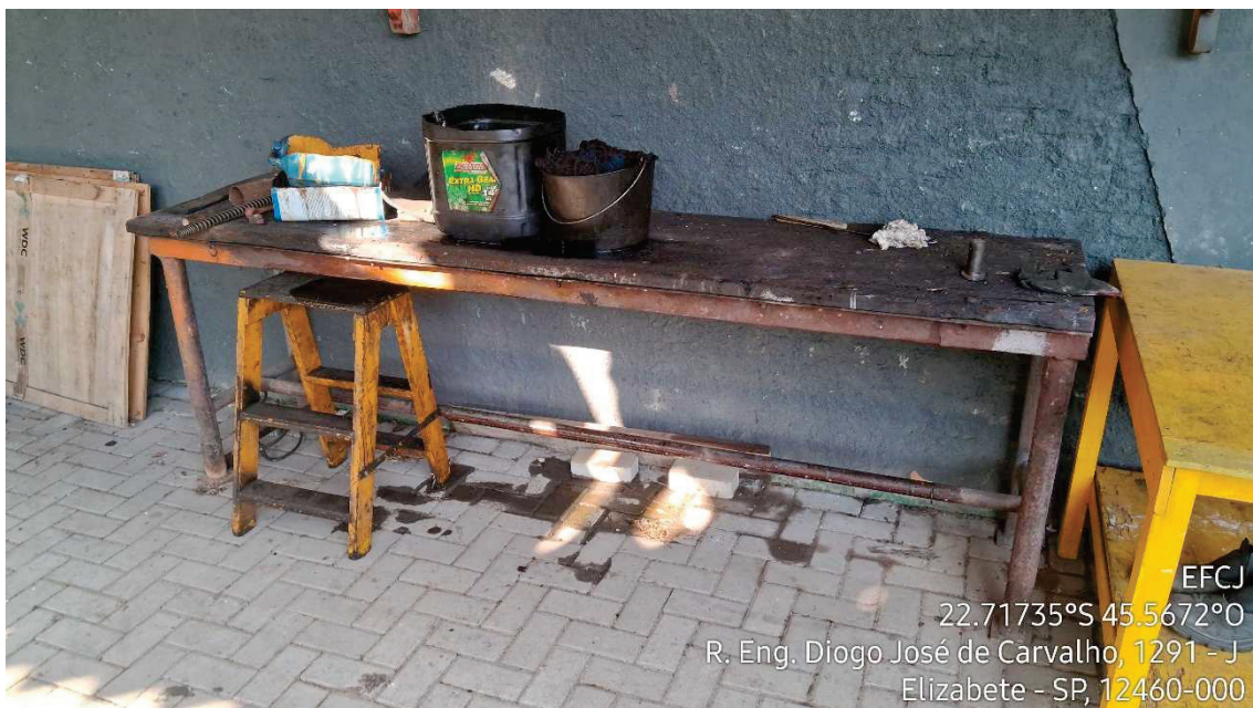
Figura 24 - Bancada de manutenção com manchas de vazamento de óleo por sobre piso de bloquetes - Pátio de Manutenção Capivari
